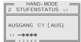
Die aktuelle Stufe ist durch Blinken gekennzeichnet. Einstellung des gewünschten Zustands über  $\uparrow$  /  $\downarrow$ . Mit ENTER wird abgespeichert und zur nächsten Stufe gewechselt. Die programmierten Zustände für die Ausgänge bleiben auch im Automatikbetrieb im Display sichtbar.
