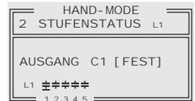
**AUS:** Ausgang ist ständig abgeschaltet z.B. um vorübergehend einen defekten Kondensator abzuschalten. Das Kondensatorsymbol dieses Ausgangs wird ausgeblendet. Es erscheint ein Bindestrich (Minus).
