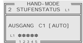
**FEST:** Ausgang ist ständig fest eingeschaltet z.B. für eine ständige Grundkompensation. Der Ausgang wird durch ein unterstrichenes Kondensatorsymbol gekennzeichnet.
