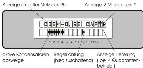
Die Regelrichtung wird durch einen geschlossenen Pfeil symbolisiert
