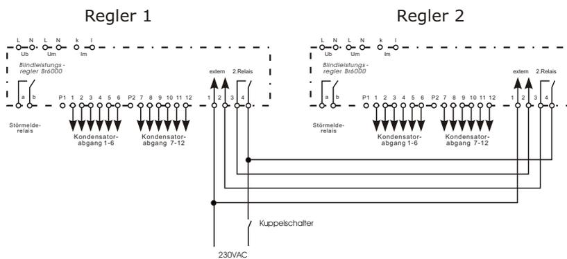
Ist der Kuppelschalter geöffnet, arbeiten beide Anlagen völlig autonom. Wird die Kupplung geschlossen, erfolgt automatisch Master-Slave-Betrieb.
