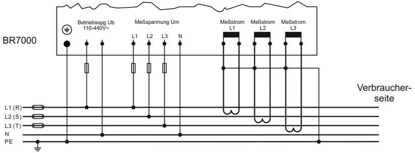
Variante 2: einphasige Messung über Stromwandler in L1
