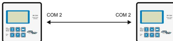
Die Betriebsart des Koppelbetriebs ( Parallelbetrieb bzw. Master-Slave Betrieb) wird im PROGRAMM-MODE unter **23 EXTERNER EINGANG** ausgewählt.
