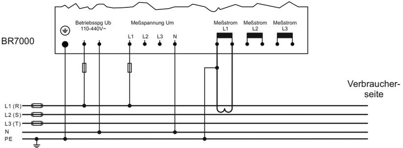
Variante 3: einphasige Messung wie Var.2, jedoch mit Eigenstrommessung in der Kompensationsanlage zur Erfassung der realen Kondensatorströme
