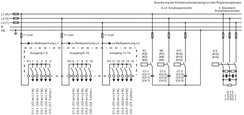
Bei o.g. Einstellung werden vom BR7000 die Kondensatoren automatisch gemäß Schaltplan zugewiesen.
