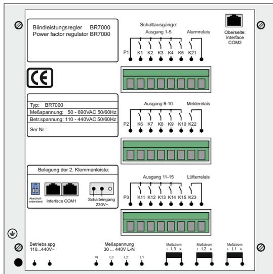
Die Zuordnung der Schaltausgänge K1...K15 zu den Kondensatoren richtet sich nach der gewählten Anschlussvariante und dem gewünschten REGEL-MODE (Programmierung / Pkt.2)
