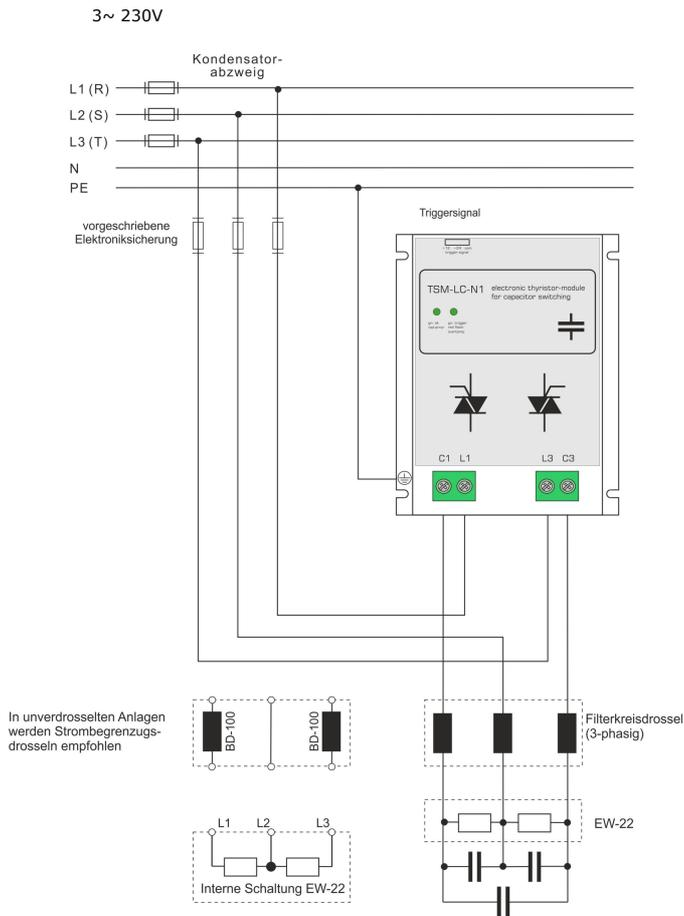
**Bild 2: Anschlußplan zweiphasige Last**
