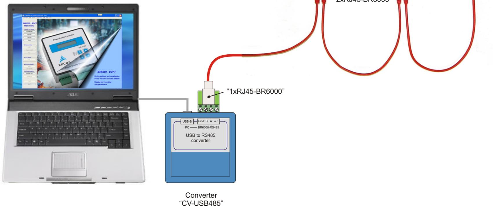
Kopplung von BR6000 / BR7000 mit mehreren MMI6000 durch Verwendung von CV-RJ45 und Standard LAN-Patchkabel (1:1)
