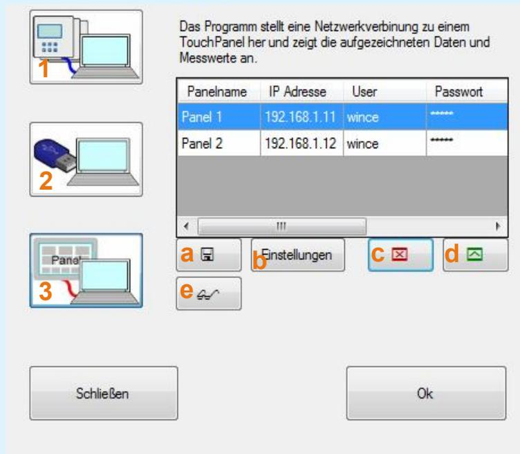
Für die Verbindung des Panels müssen folgende Parameter bekannt sein: IP-Adresse des Panel, Benutzername/Passwort (Standard: wince/vipatp), FTP-Port 21/22 & TCP-Port 55 müssen zur Verfügung stehen.
